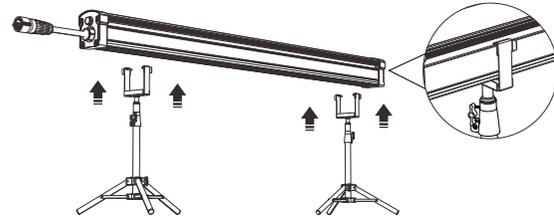
3. Lösen Sie den Drehknopf, um die Höhe des Stützrohrs anzupassen, und ziehen Sie dann den Drehknopf an, um die Höhe zu fixieren.
